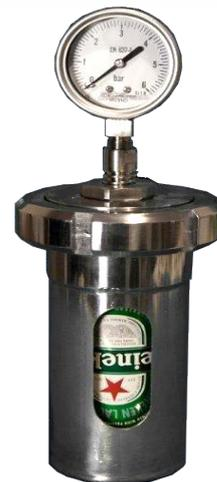
Strumento adatto per misurare la pressione e quindi il contenuto di CO2 esistente nelle lattine in metallo (birra, coca cola, sprite, ecc). L'afrometro per lattine misura rapidamente e con alta precisione la pressione presente all'interno di una lattina in alluminio. La misurazione è resa possibile con un ago in acciaio INOX opportunamente sagomato e forato.
